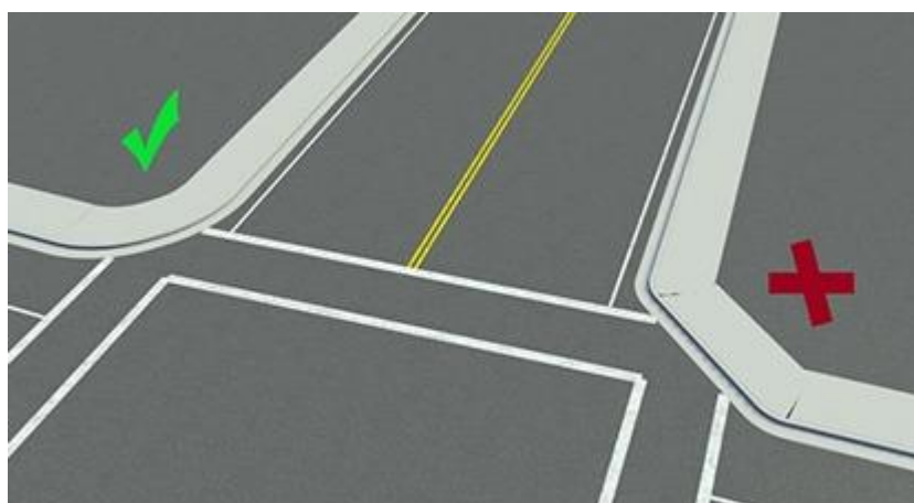
Рисунок 3 – Пример правильной геометрии(слева) и неверной(справа)
