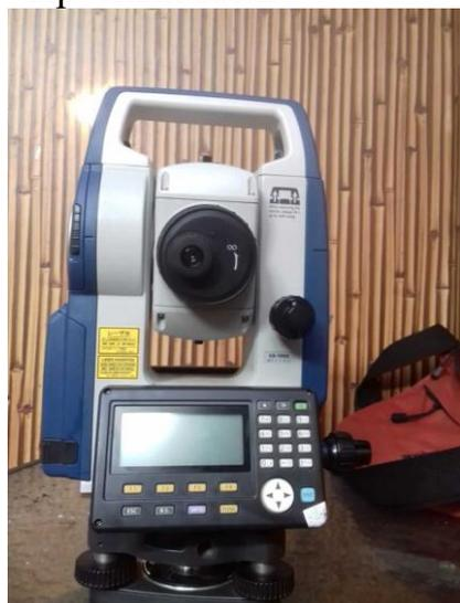
Рисунок №1 – Электронный тахеометр SOKKIA CX 105
