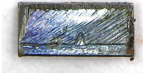
Рис.4 Образец стали Ст3СП в водном растворе ПО-1 (6 %) и бикарбоната натрия (1 %)
